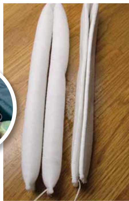
Vannabsorbent før og etter vannopptak.
